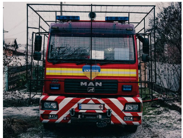
Автомобіль ДСНС у Нікополі з протикумулятивною решіткою для захисту від дронів. Джерело: Едвард Метьюз 286 .
