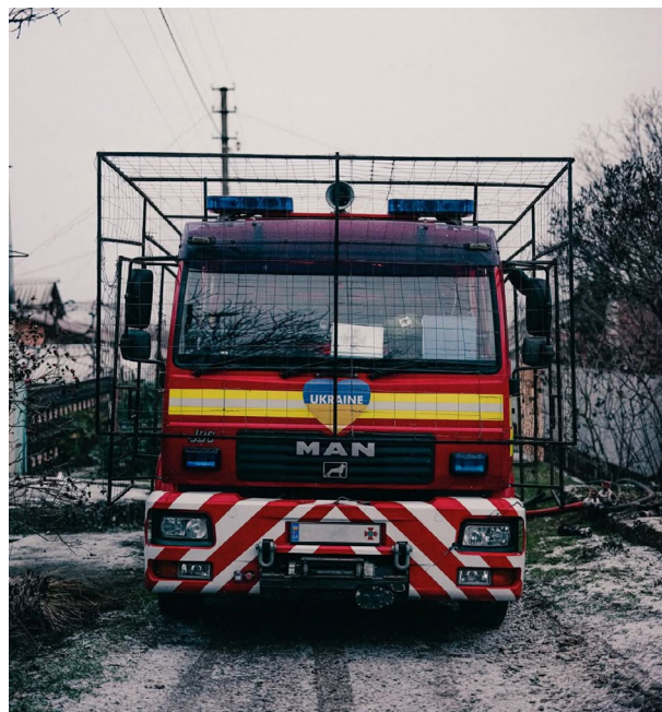
Un véhicule du SUE à Nikopol, doté d'un blindage à lames pour se protéger des drones, décembre 2025. Source : Edward Matthews. 303
